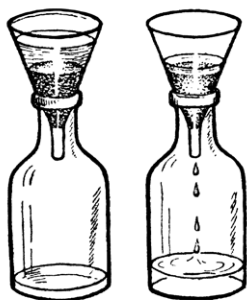
Рис. 4. Как вода протекает через глину и песок. Слева опыт с глиной, справа — с песком.
